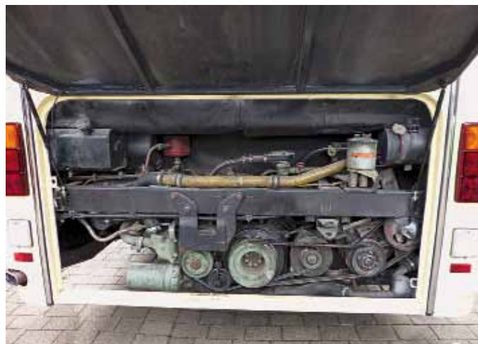
Kraftquelle im Tübinger MB O 305 ist der liegende Reihensechszylinder OM 407 hA mit 11.334 cm 3 Hubraum und 177 kW (240 PS) Leistung.
