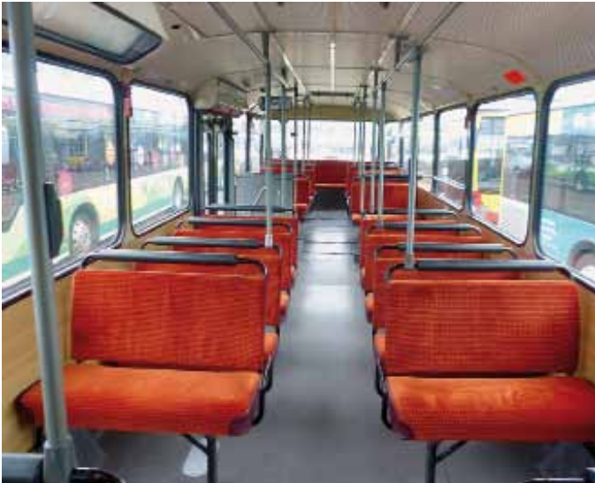
In der vollbestuhnten Variante bietet der MB O 305 nicht weniger als 44 + 1 Sitzplätze.
