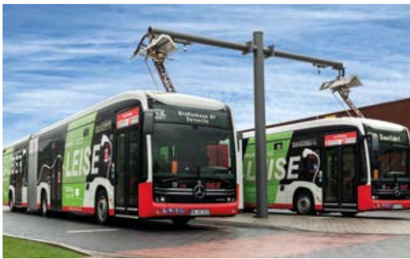
Künftig werden E-TüBusse mit Pantographen aufgeladen.
