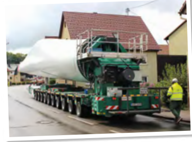
Ende September sind die Rotorblätter per Selbstfahrer (SPMT) auf dem Weg in den Windpark.
